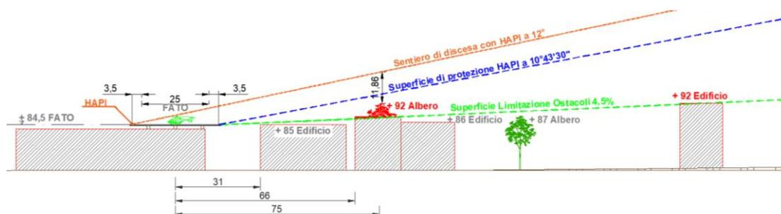
Fig. 10.19 - Superficie di protezione HAPI avvicinamento prua 322°.
