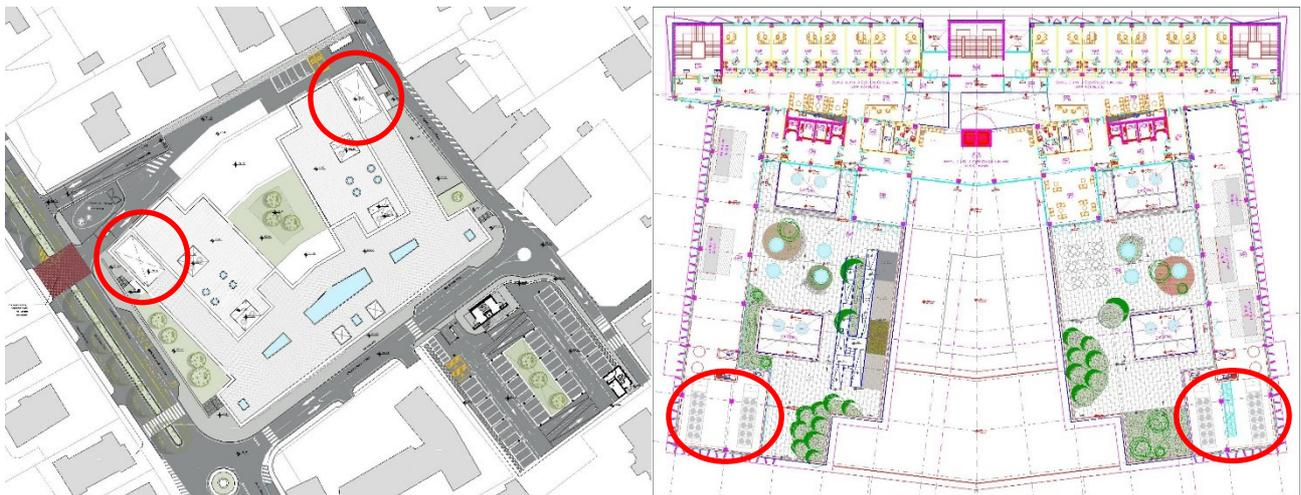
Figura 5 – Piante delle coperture e livello + 3 con identificate le sorgenti PdC
