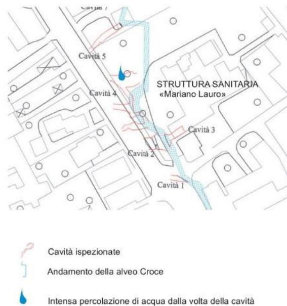
Fig. 9. Planimetria delle cavità accessibili (stralcio progetto).
