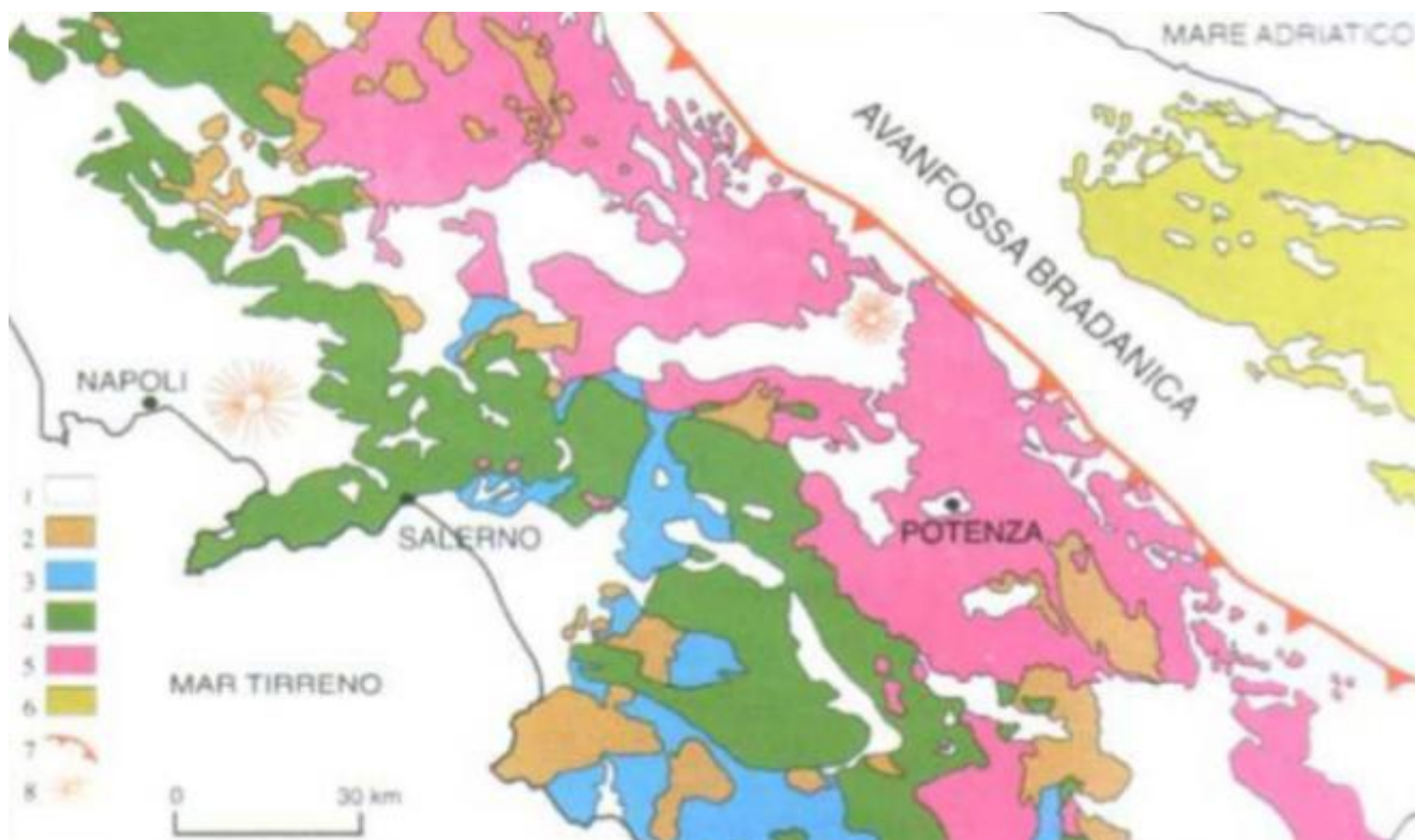
Schema geologico dell'Appennino campano – lucano. 1: depositi clastici plio – quaternari e vulcaniti quaternarie; 2: depositi miocenici; 3: unità liguridi; 4: carbonati meso – cenozoici della Piattaforma Appenninica; 5: unità lagonegresi; 6: carbonati meso – cenozoici della Piattaforma Apula; 7: fronte di sovrascorrimento della catena; 8 Edifici vulcanici
