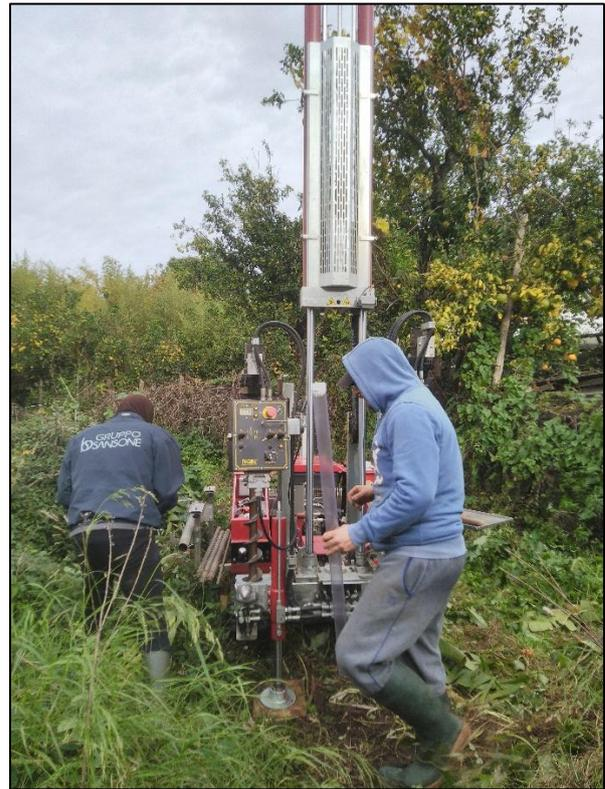
**Figura 2.3** – Prelievo di campioni nel sottosuolo con il campionatore PAGANI con la tecnica di perforazione Direct Push
