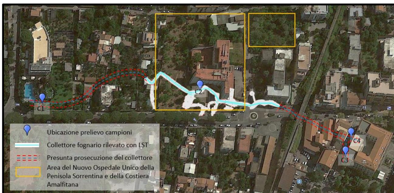
Figura 1.19 - Ubicazioni dei campioni di acqua prelevati nel collettore fognario.
