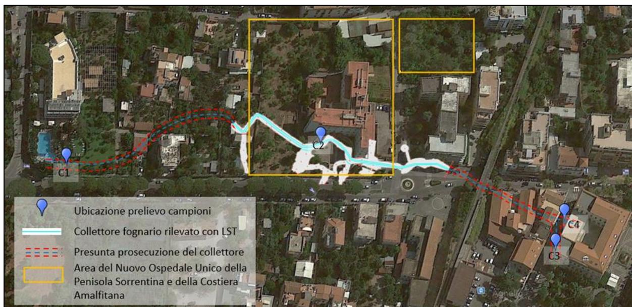
Figura 1.3 - Ubicazioni dei campioni di acqua prelevati nel collettore fognario.
