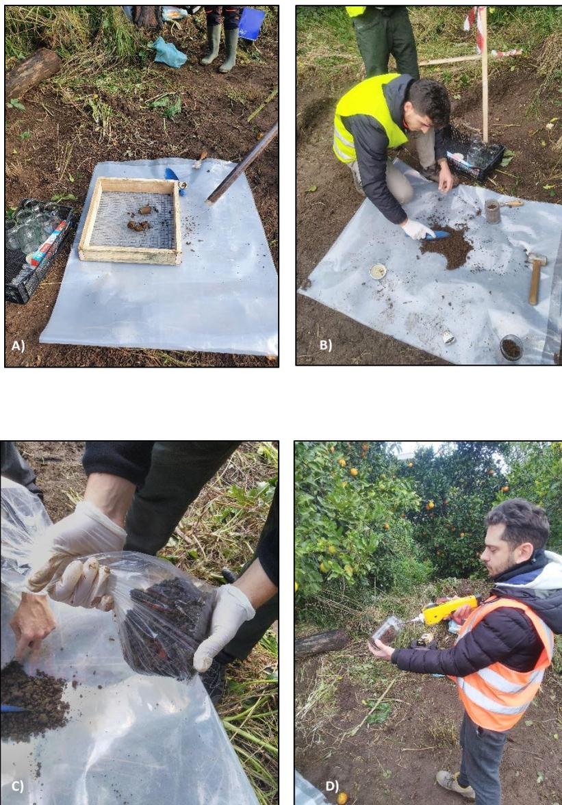
**Figura 2.4** – Operazioni di prelievo dei campioni: A) Setacciatura B) Quartatura C) Omogeneizzazione D) Rilievo VOC
