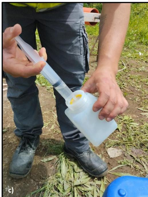
**Figura 2.7** – *Tecnica di campionamento: a) prelievo di acqua non torbida alla profondità della falda con apposita pompa sommersa, b) misura dei parametri chimico-fisici con sonda parametrica, c) esempio di modalità di campionamento*
