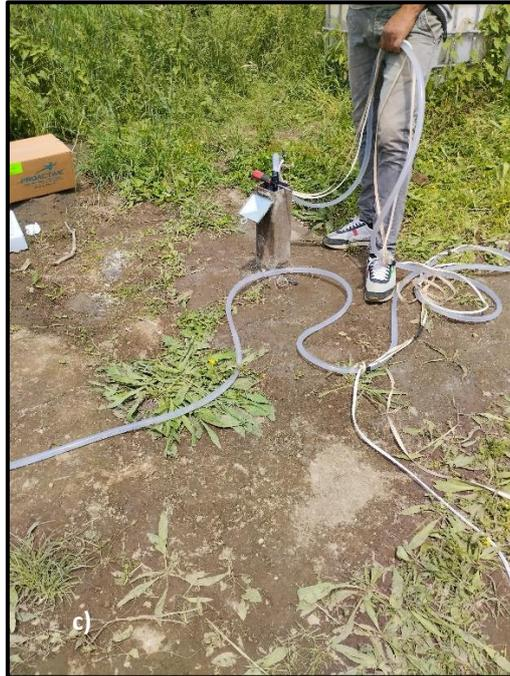
Figura 2.6 – Spurgo dei rispettivi piezometri: a) S01P, b) S08P, c) S13P
