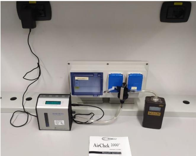
**Fig.8:** Calibrazione del flusso di aspirazione del sistema pompa – preselettore IOM
